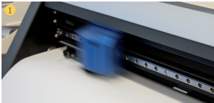
1 Colocar el STONE-FLOCK en el plóter y recortar la plantilla deseada. Position STONE-FLOCK in the vinyl cutter and cut out required stencil.
